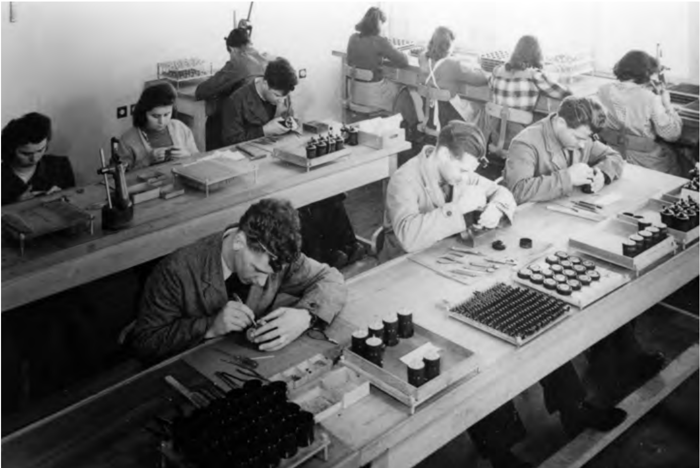
Zusammenbau Hauptkörper Curta I um 1950. Archiv E. Anthes
