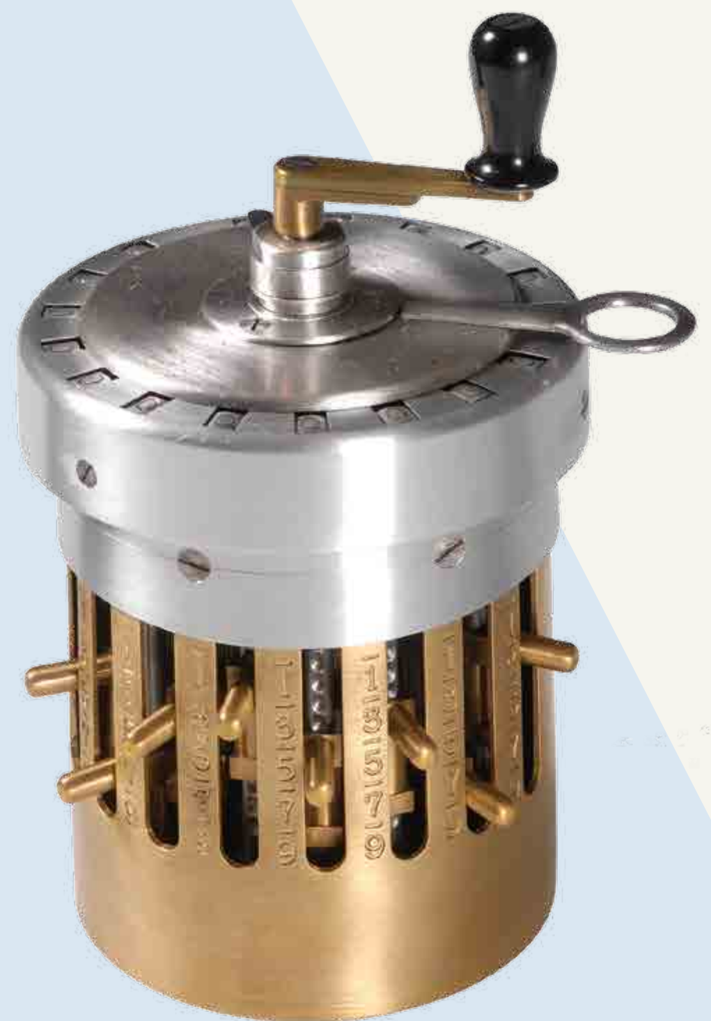
Erster Prototyp der Rechenmaschine, Wien, 1938 Foto: Liechtensteinisches LandesMuseum (Sven Beham)
