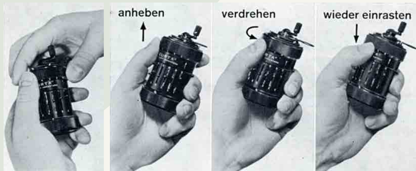
Versetzen des Rundwagens bei einer Multiplikation Fotos: Hansjörg Nipp
