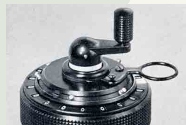
Kurbel anheben für Subtraktion Foto: Hansjörg Nipp
